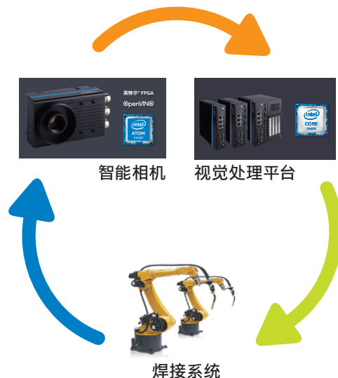
图二 3D 机器视觉焊接解决方案系统架构
